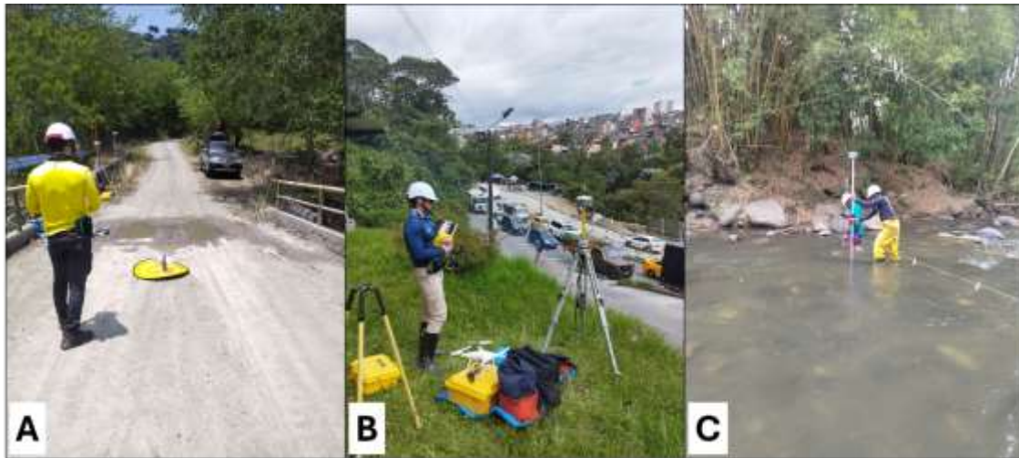
Figura 7. A) levantamiento topográfico con dron, B) levantamiento topográfico con GPS, C) Levantamiento sección transversal.
