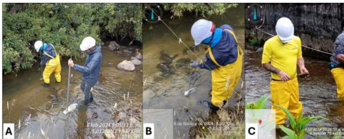
Figura 12. Realización de aforo sólido, Medición de sedimentos de fondo (A), sedimentos suspendidos (B) y caracterización del lecho (C)
