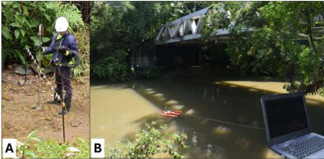
Figura 8. Realización de aforo líquido por vadeo (A) y usando el ADCP (B)
